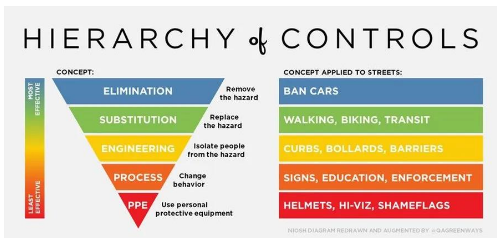
Fig. 25 Concept de « Hierarchy of controls » du National Institute for Occupational Safety and Health (NIOSH) adapté aux questions liées au vélo par Queen Anne Greenways.
