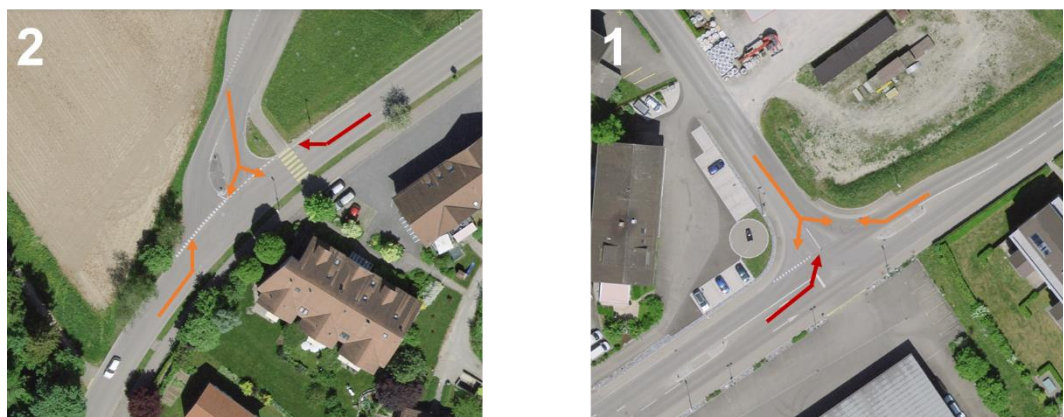
Abb. 80 Relevante (orange und rot) und massgebende (rot) Ströme für die Erschliessung des Standorts Marthalen-Schilling
