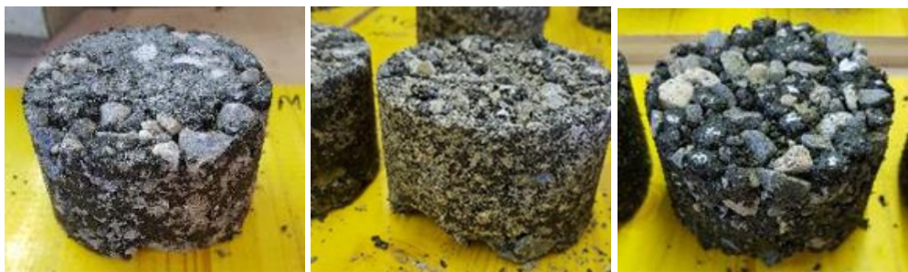
Fig. 54 Eprouvettes Marshall : a) M5, b) M6, c) M9
