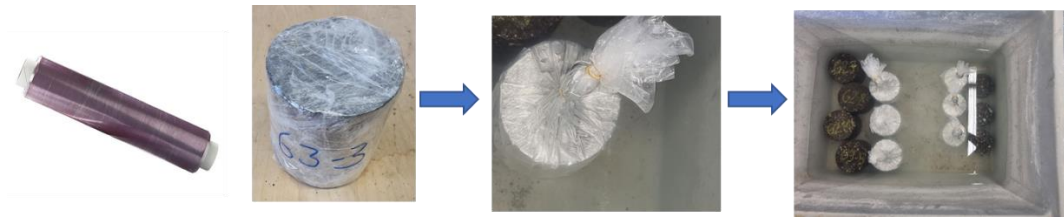
Fig. 93 Groupe 1: stockées dans l'eau à 20°C
