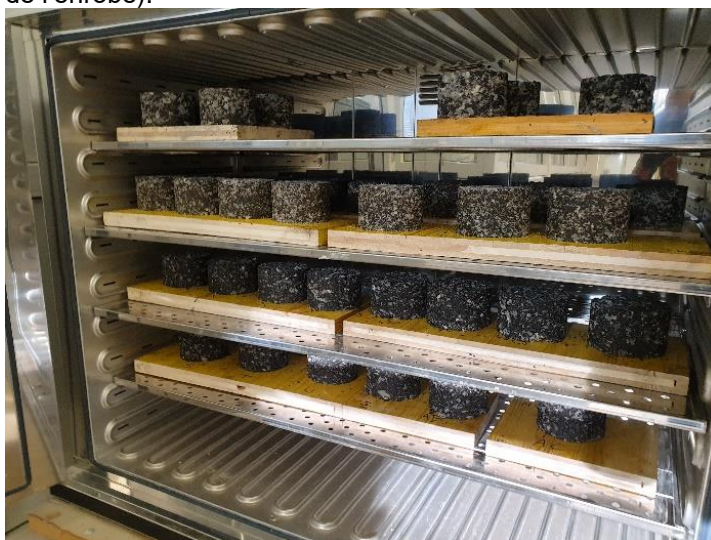
Fig. 55 Conditionnement accéléré (température et humidité contrôlées)
