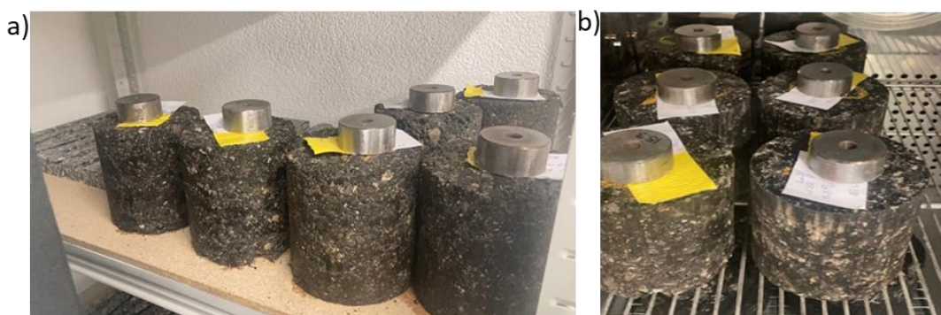
Fig. 28 Eprouvettes Duriez AC B 16 0% RAP Ec compactées à une pression de : a) 40 kN ; b) 120 kN
