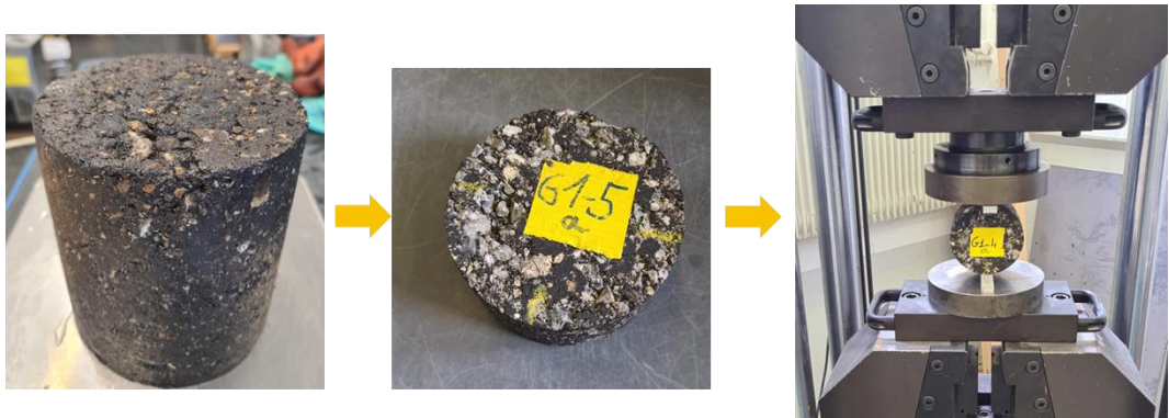
Fig. 123 Préparation de l'éprouvette Duriez pour l'essai ITS
