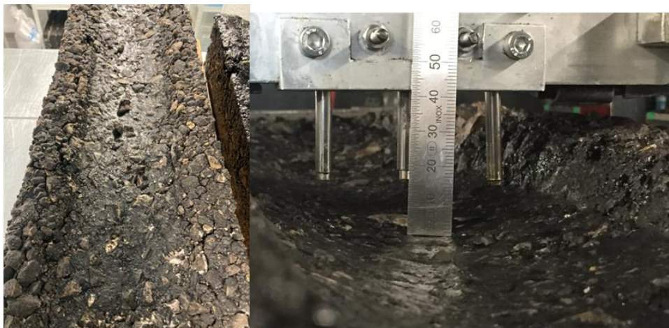
Fig. 43 Plaques d'orniérage après l'essai
