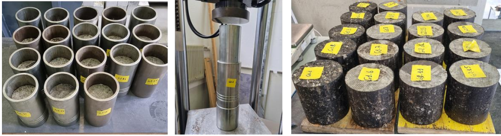
Fig. 96 Etapes de fabrication des éprouvettes Duriez
