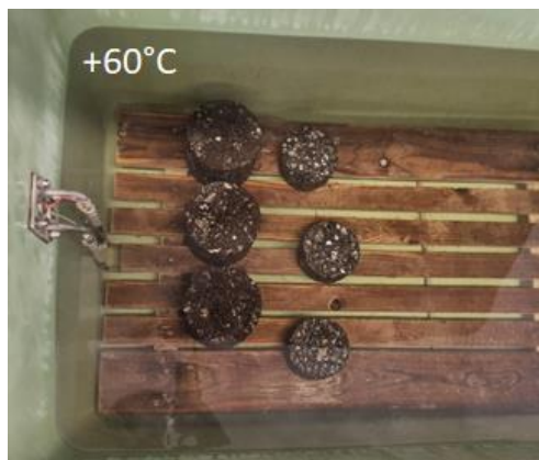
Fig. 94 Eprouvette humides stockées à 60°C
