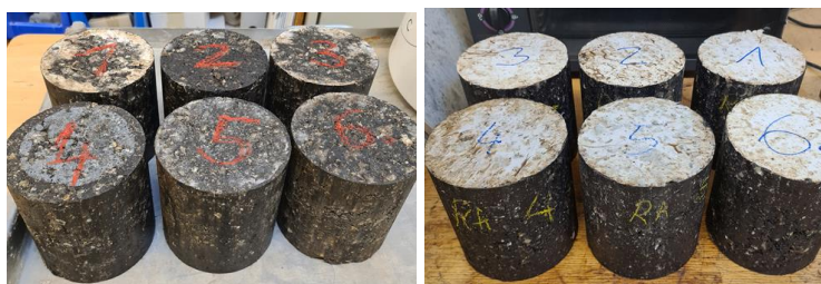
Fig. 125 Eprouvettes a) Sans RAP b) avec RAP
