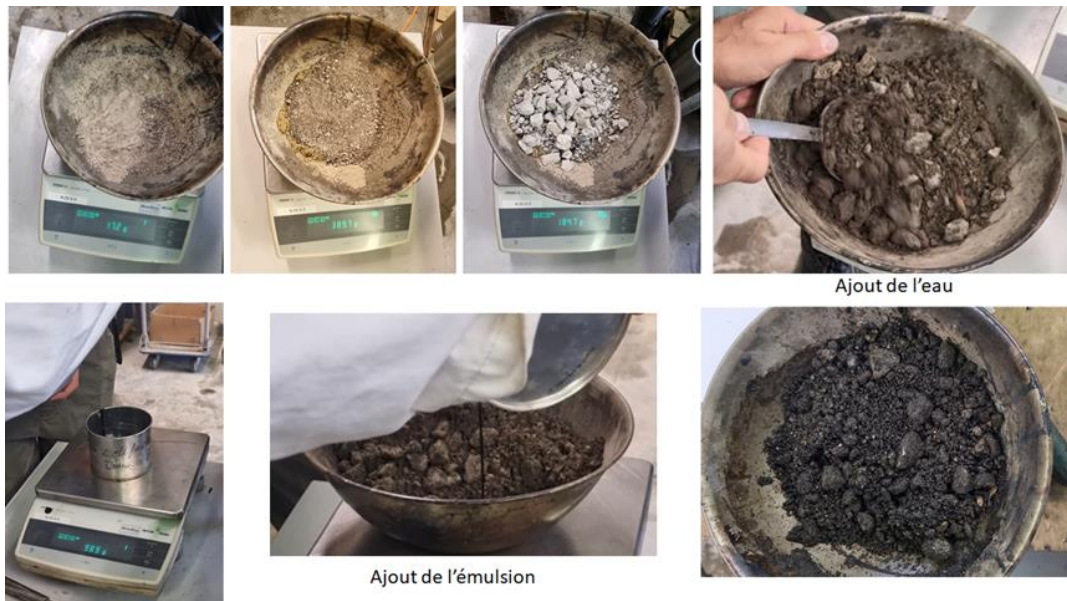
Fig. 84 Etape manuelle de fabrication d'enrobé à froid
