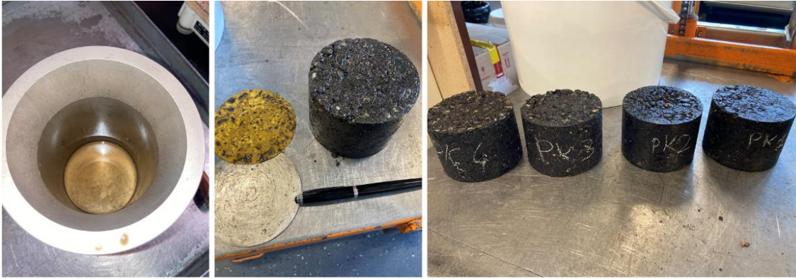
Fig. 26 Eprouvettes PCG (100 x 65 mm)
