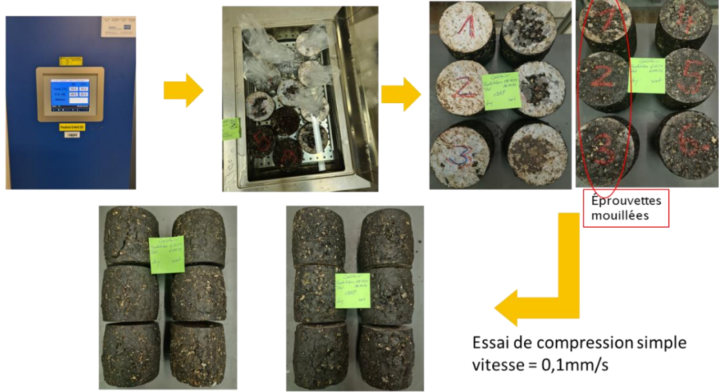
Fig. 129 Etapes de stockage des éprouvettes duriez
