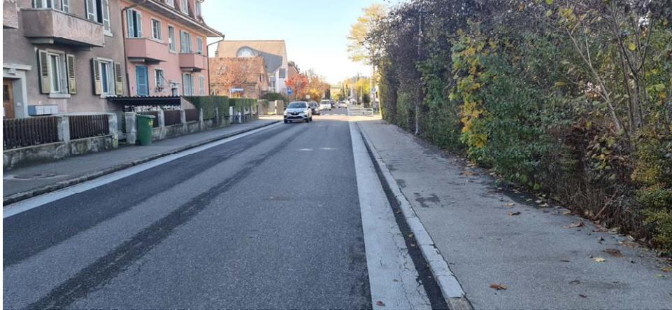
**Abb.5** Längsstreifen am Fahrbahnrand zur Verdeutlichung von Tempo 30 (optische Verschmälerung) (Brünnenstrasse, Bern)
