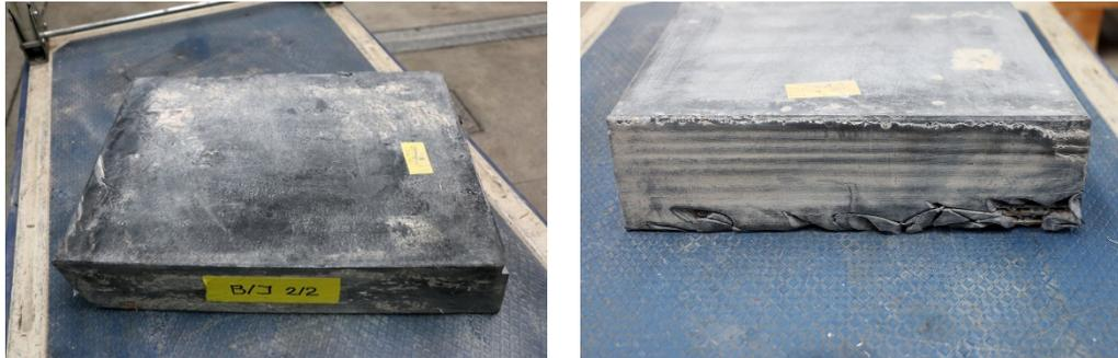
**Abb. 42** Elastomerlager des Viaduc de Matran (*links*). Beschädigungen durch den Ausbau an einem Elastomerlager (*rechts*).
