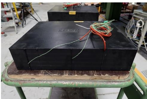
**Abb. 6** Elastomerlager Mageda LASTO@BLOCK Typ B mit Kabeln der eingebauten Temperatursensoren.
