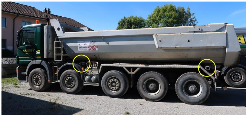
**Abb. 79** Lage der Sensoren am Fahrzeug.
