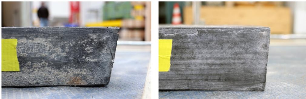
**Abb. 44** Bleibende Scherverformung des Lagers B/J 2/2 des Widerlagers Bern (*links*) und des Lagers V/J 1/2 des Widerlagers Vevey (*rechts*).
