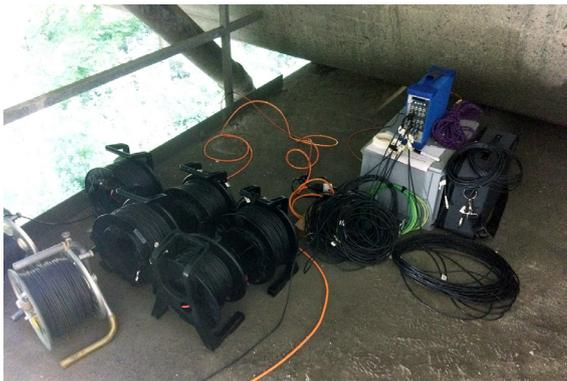
**Abb. 77** Akustik- & Schwingungsanalysator OROS OR36 mit Kabelrollen.
