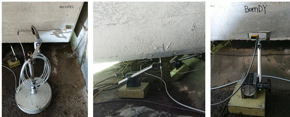
**Abb. 76** Wegsensor HBM W200 zur Messung der Längsverschiebung (links). Wegsensor HBM WI5 vertikalen Einsenkung und der Rotation (Mitte) und Wegsensor Baumer OADM 12U6430/S35A zur Messung der Querverschiebung (rechts).
