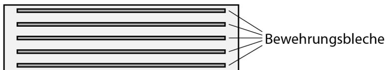
Abb. 2 Aufbau eines unverankerten, bewehrten Elastomer-Blocklagers.
