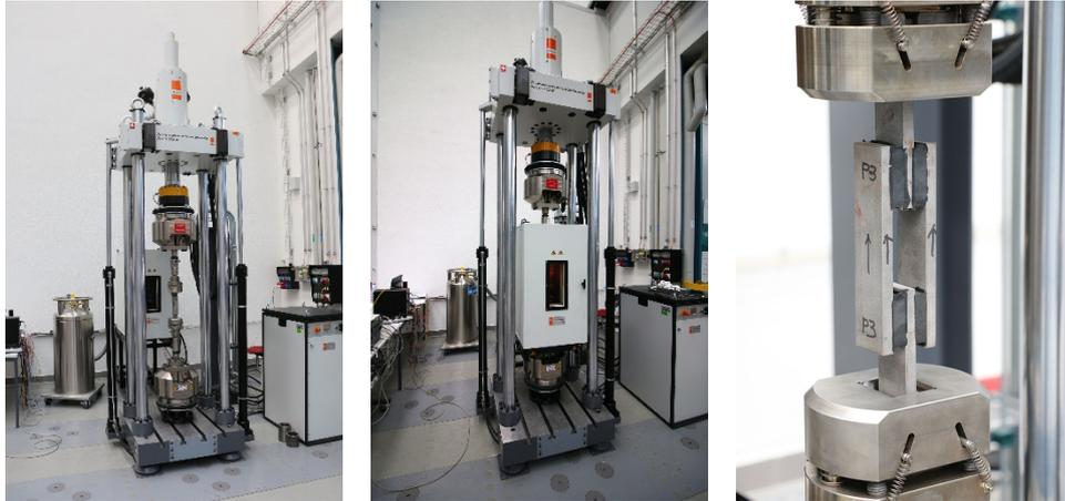
**Abb. 22** Prüfmaschine mit und ohne Temperaturkammer und eingebaute Quadrupelprobe.
