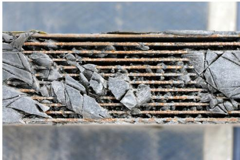
**Abb. 43** Aufbau des stark beschädigten Elastomerlagers B/A 1/2.
