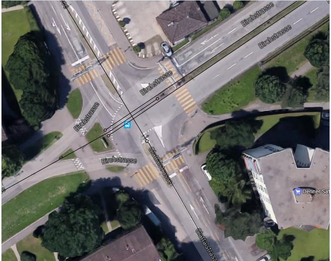
**Abb. 7** Anwendung der Regeln zur Modellierung der RBBS-Achsen an Kreuzung Glattalstrasse, Zürich-Seebach
