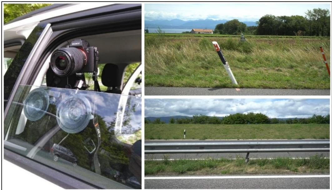
**Abb. 5** Kameraposition und Bildbeispiele mit *Rolling-Shutter-Effekt* bei ca. 85 km/h.
