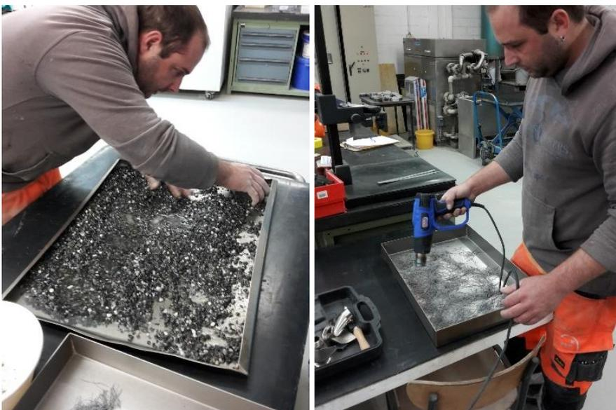
**Abb.3** Separieren und Trocknen der Fasern
