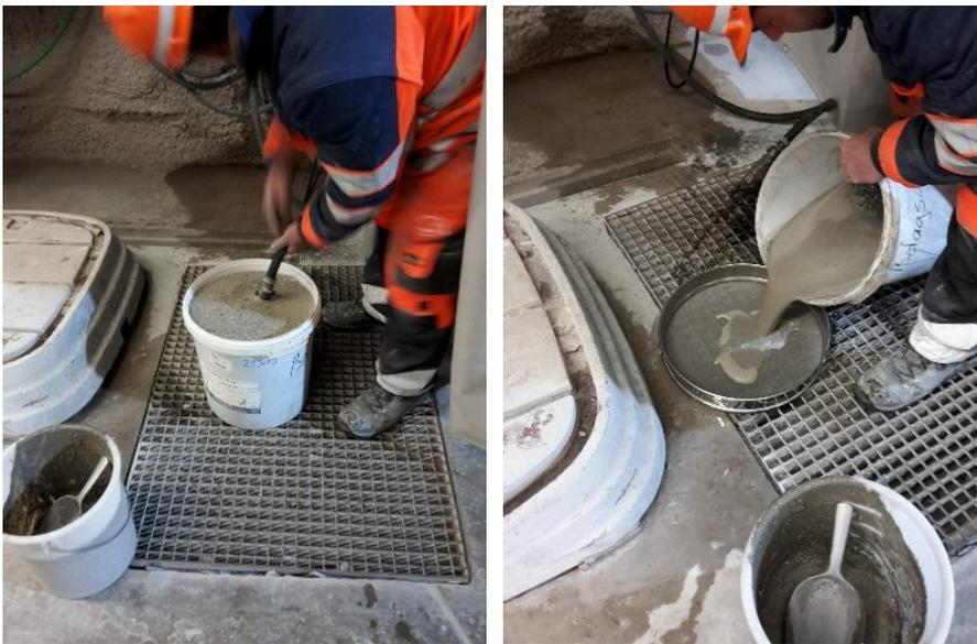
**Abb.2** Auswaschen der Fasergehaltsproben
