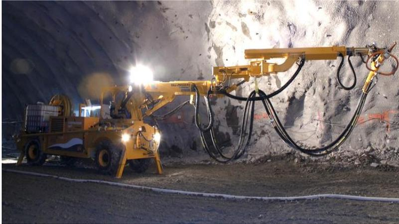
**Abb.9** Putzmeister PM 500 Spritzbetonmanipulator
