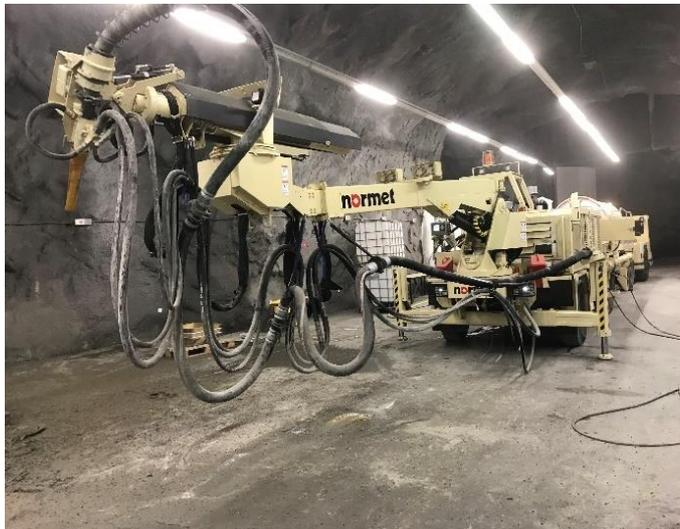
**Abb.6** Normet Spraymec 8100 VC Spritzbetonmanipulator
