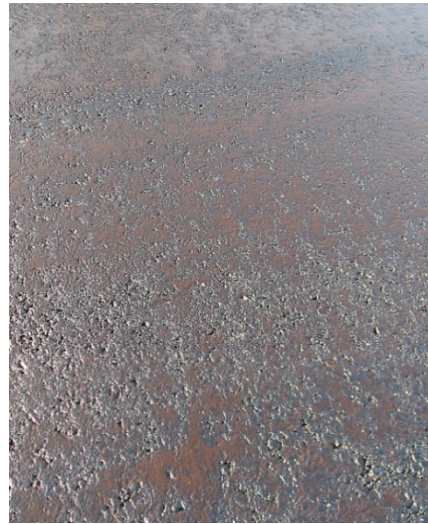
Abb. 25 Haftkleber: Brechvorgang nach 2 Minuten.
