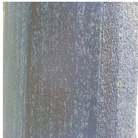
Abb. 11 Veränderung des Haftklebers nach 10 Minuten (zweiter Abschnitt).
