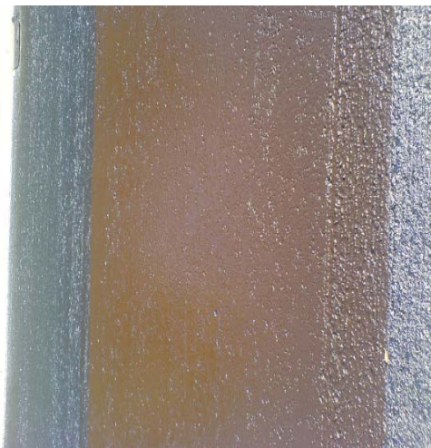
Abb. 11 Veränderung des Haftklebers nach 10 Minuten (zweiter Abschnitt).
