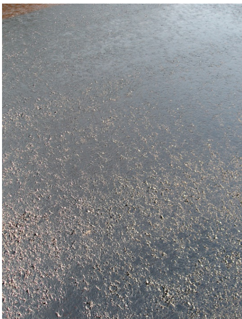
Abb. 26 Haftkleber: Brechvorgang nach 6 Minuten.
