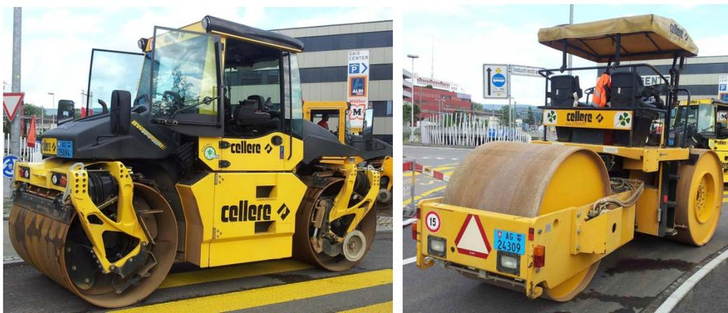
Abb. A 3 Dynamische (links) und statische Walze (rechts) beim Einbau eines SDA 8.
