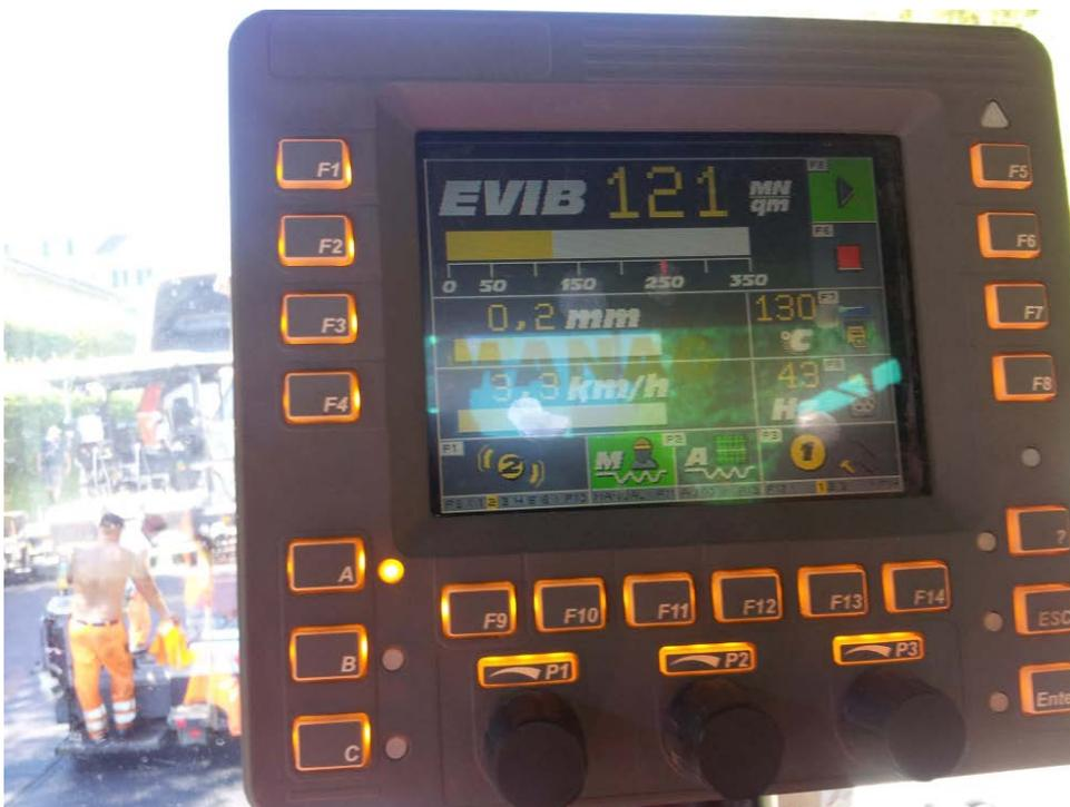
**Abb. A 6** Computermonitor einer „intelligenten“ dynamischen Walze im Einsatz.
