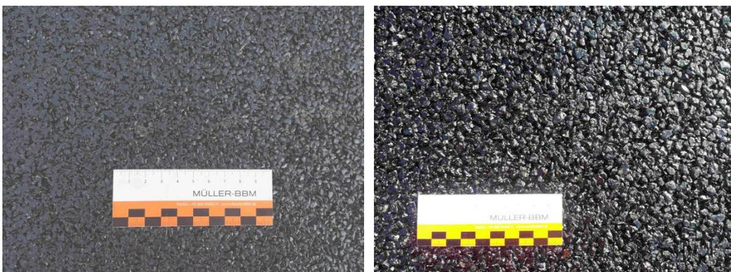
**Abb. A 11** Detailfoto eines SDA 4 (links) und eines SDA 8 (rechts) unmittelbar nach Einbau.
