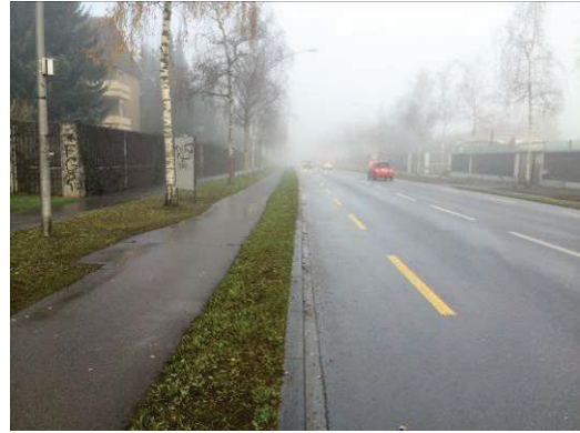
Abb. 123: A2, Doppelangebot: Radstreifen, und Richtungsradweg, Fahrtrichtung Kehrsatz
