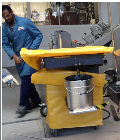
Abb. 15 Empa Schaumbitumenmischer, Herstellung Mischgut
