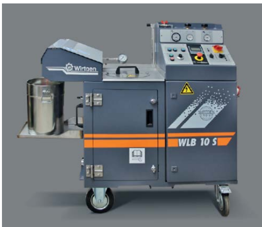
Abb. 15 Empa Schaumbitumenmischer, Herstellung Mischgut
