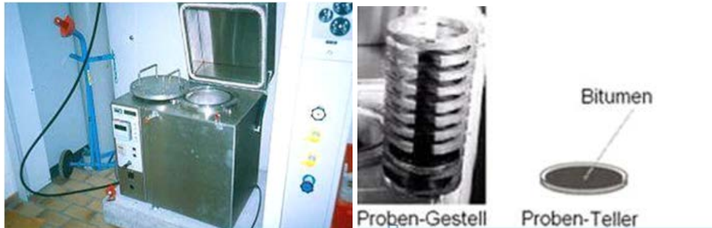
Abb. 13 PAV, recht Gesamtansicht, links, Probenteller und Probentelereinsatz
