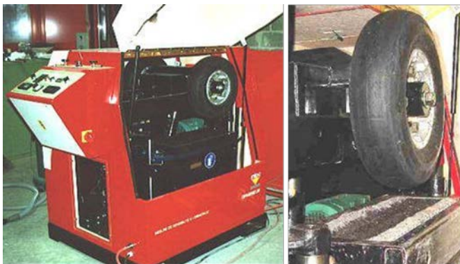
Abb. 6 Prüfeinrichtung für den Spurbildungstest mit großem Rad nach EN 12697-22 [28].
