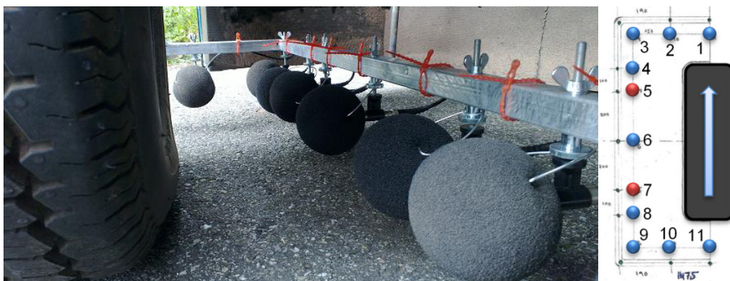
Abb. 11 Messbereit bestückte Halterung mit den elf Mikrofonen mit Windbällen. Rechts die Positionierung der Mikrofone um den Messreifen; die nach Norm obligatorischen Positionen 5 und 7 sind in rot dargestellt.
