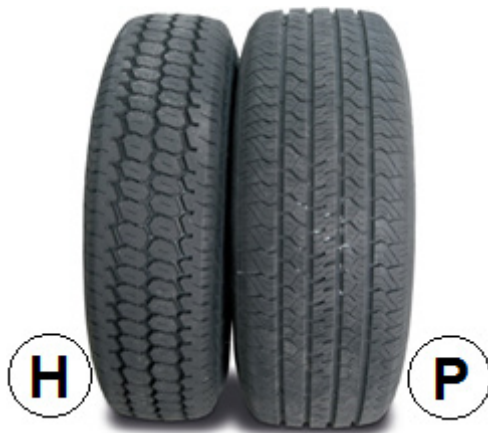
Abb. 12 Verwendete Messreifentypen gemäss ISO 11819-2.
