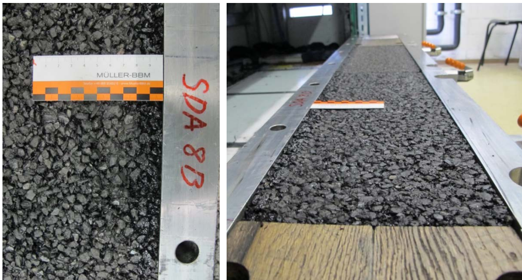
Abb. 61 Oberfläche der Probeplatte SDA 8B am 30.03.2015 nach 4'288'492 Überrollungen.
