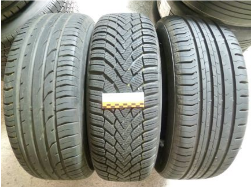
Abb. 44 Messpneus Premium Contact, Winter Contact und Eco Contact für die Kontrollierte Vorbeifahrt (CPB).
