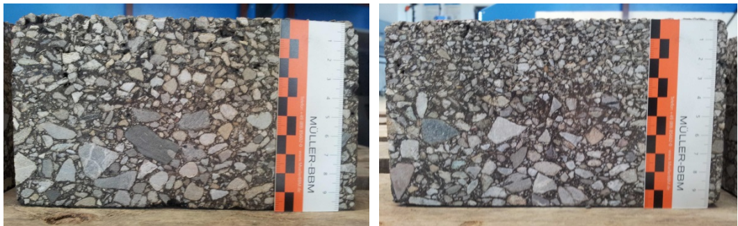
Abb. 53 Schnittfläche der untersuchten Probekörper. Links: SDA 8C Fulenbach; rechts: SDA 6B, Kestenholz.
