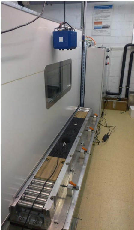
Abb. 32 Schallabsorptionsgradmessung einer Prüfplatte im IMPACT bei heruntergelassener Trennwand.
