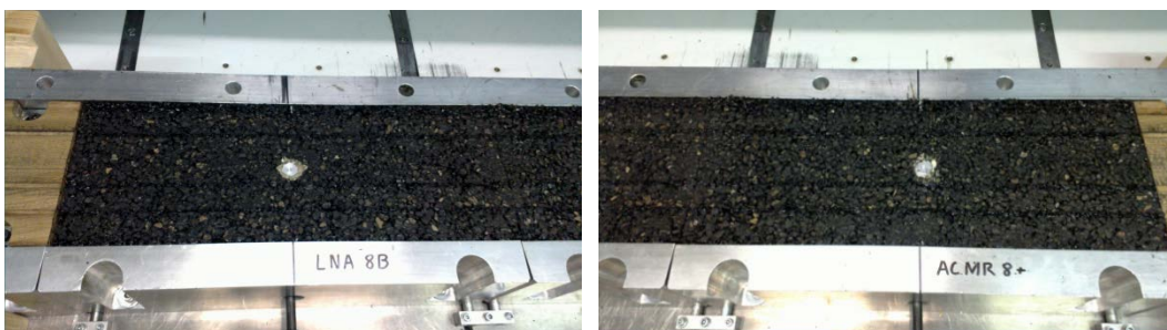
Abb. 36 Applikation der Kraftverteilungsplättchen auf SDA 8B und AC MR 8+ Prüfplatten
