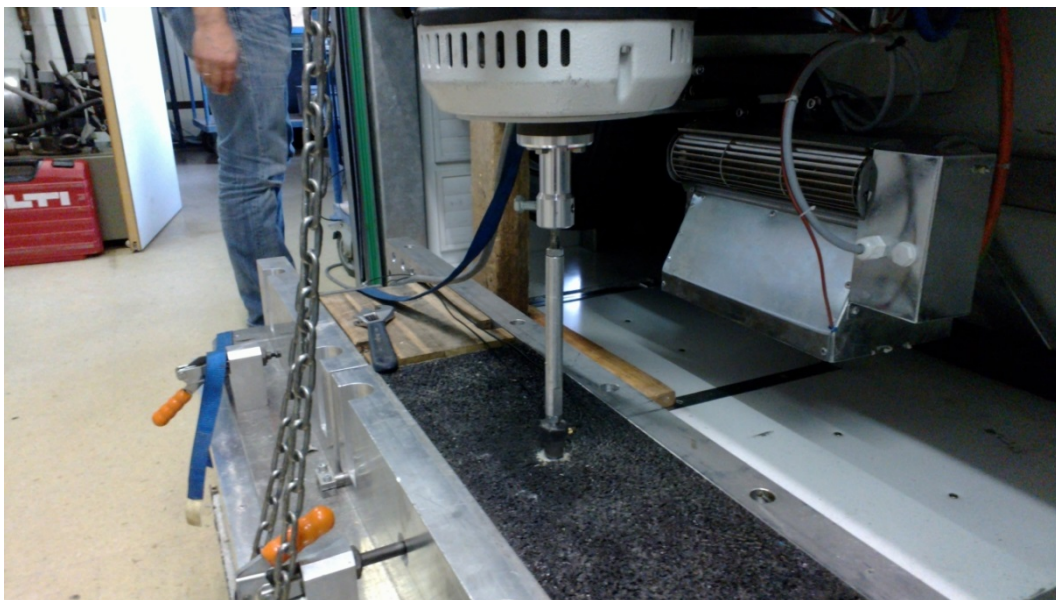
Abb. 35 Messung der mechanischen Impedanz einer Prüfplatte im IMPACT.
