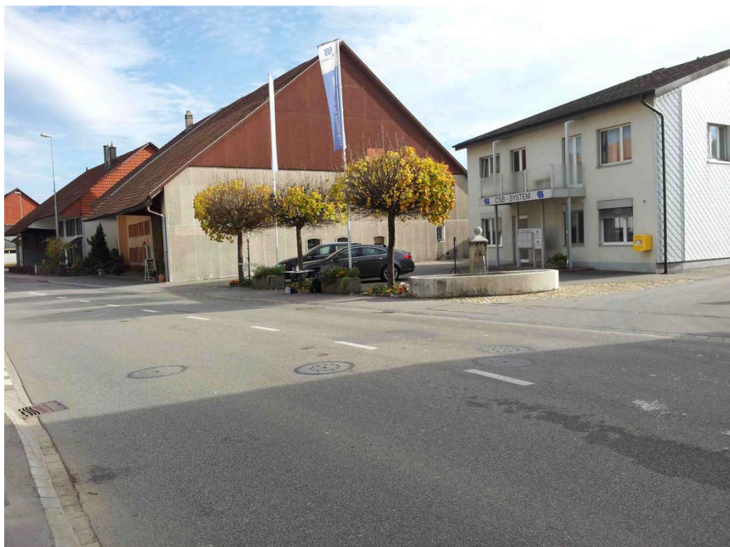
Abb. 42 Situation am Messstandort des SDA 6B Belags in Kestenholz. Der Messpunkt lag bei dem Campingtisch in der Bildmitte. Blumenkübel und ein Brunnen als mögliche Streukörper liessen sich nicht vermeiden, erwiesen sich aber im Nachhinein nicht als signifikant störend bei der CPB-Messung.
