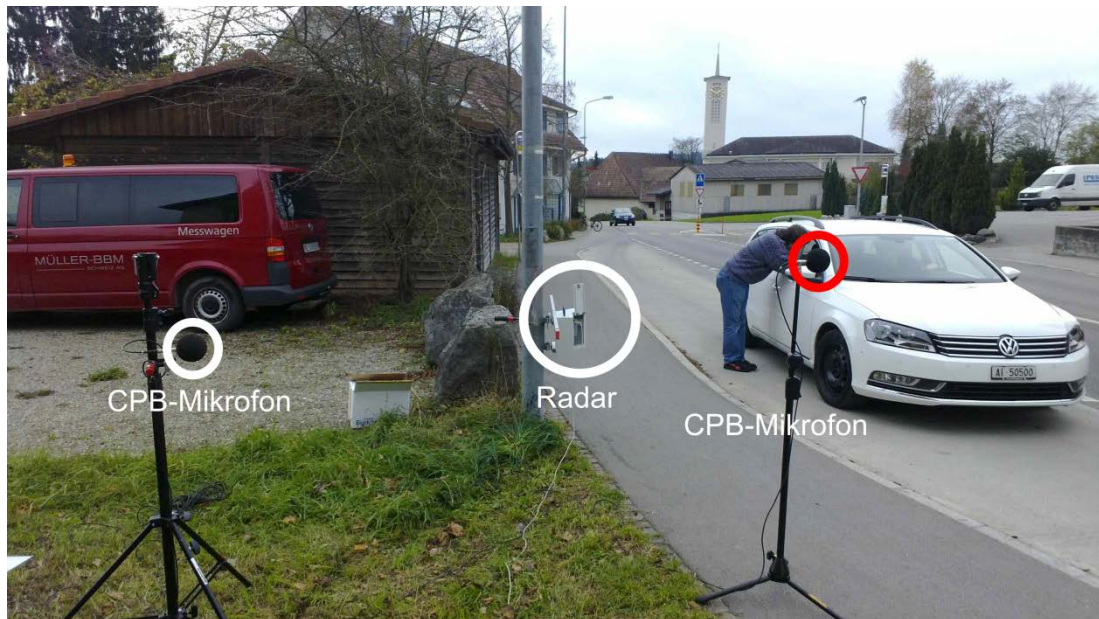
Abb. 43 Messaufbau bei der CPB-Messung am SDA 8C Belag in Fuluibach. Das Vorbeifahrtgeräusch des Messfahrzeugs (rechts) wird von zwei Messmikrofonen aufgenommen, während die Fahrgeschwindigkeit via Radar gemessen wurde.
