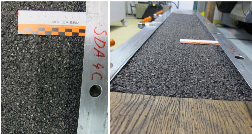
Abb. 62 Oberfläche der Probeplatte SDA 4C am 30.03.2015 nach 4'288'492 Überrollungen.
