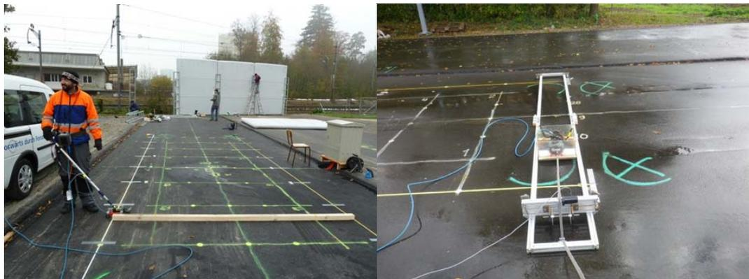
**Abb. 53** Radarantenne auf dem Messfeld, Messkampagne vom 16.04.13 (links) und angepasste Messapparatur, Messkampagne vom 18.11.13 (rechts)
