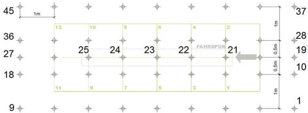
**Abb. 23** Positionen der einzelnen FWD-Messungen
