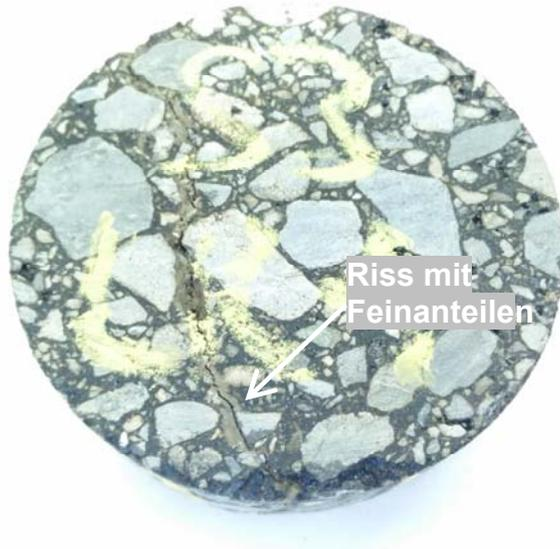
**Abb. 73** Riss im Bohrkern LK1: Blick von unten
