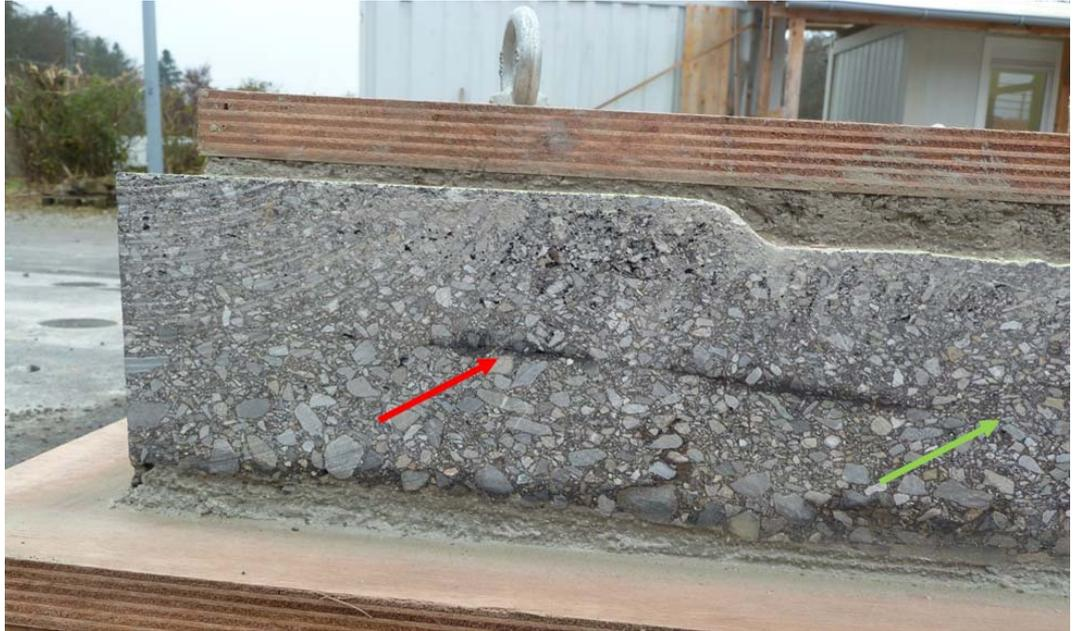
**Abb. 64** Riegel mit stark (roter Pfeil) oder schwach (grüner Pfeil) hervortretender Schichtgrenze
