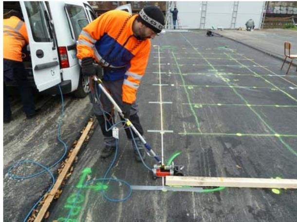
**Abb. 25** Positionen der GPR-Messungen
