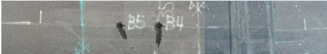
Abb. 90 Visueller Zustand der Belagsoberfläche nach 300'000 Überrollungen
