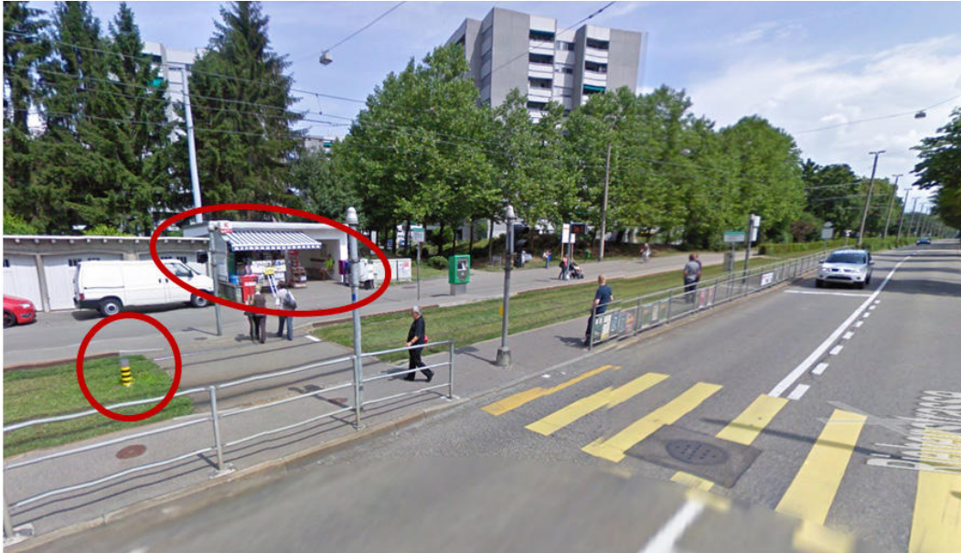
Abb.10 1-Kammer-Signalgeber mit Strassenbahnsymbol, zusätzlich „Gleisindianer“ (kleine Signalsäule mit Blitzlicht, Übergang beim Knoten Riehenstrasse/ Im Surinam, Basel, Basler Verkehrsbetriebe, 613'001 268'527) [Bild: Google © 2014, Juni 2009, Google Street View]
