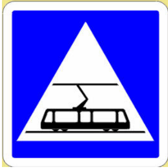
Abb.1 Signal zur Kennzeichnung einer Querung von Strassenbahngleisen in Frankreich (Panneau de type C20c) Analog dem Schweizer Signal 4.11: Standort eines Fussgängerstreifens. Das Signal entspricht dem 1.18 (siehe Abb. 43) in der Schweiz. In Frankreich wird diese Anordnung konsequenter umgesetzt als in der Schweiz. In der Schweiz ist es nur bei Bahnübergängen vorgeschrieben nicht aber im übrigen Strassenbahnbereich (nur Hinweis in RTE Bahnübergang [19]).
