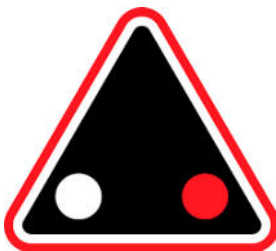
Abb.45 Rotes Wechselblinklicht (SSV 3.20)
