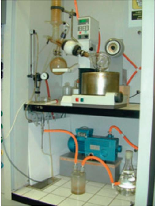
Fig. 2.2 Exemple d'appareillage de récupération du liant
