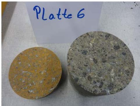
Abb. 7.17 Bohrkern der Platte 6, MA16/FLK PMMA/Beton nach der Scherprüfung. Die Schichttrennung erfolgte zwischen FLK-PMMA und Betonuntergrund
