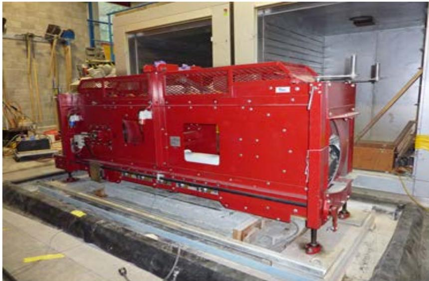
Abb. 5.1 Mobiler Verkehrssimulator MMLS3 im Labormaßstab 1:3
