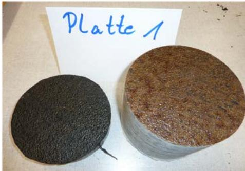
Abb. 7.12 Bohrkern der Platte 1, MA16/PBD APP/Beton nach der Scherprüfung. Die Schichttrennung erfolgte zwischen PBD und Epoxidversiegelung
