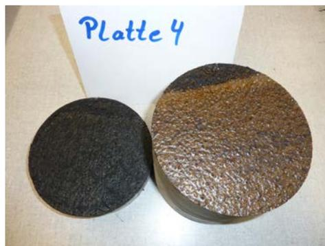
Abb. 7.15 Bohrkern der Platte 4, MA16/PBD SBS/Beton nach der Scherprüfung. Die Schichttrennung erfolgte zwischen PBD und Epoxidversiegelung
