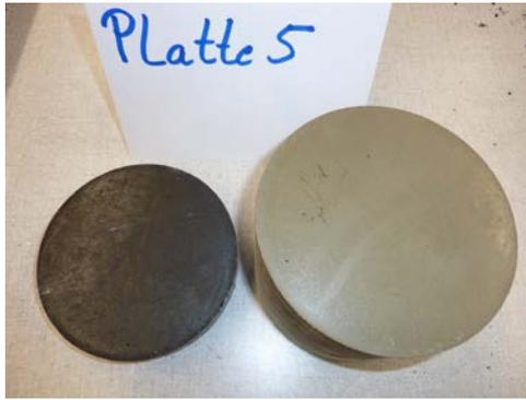
Abb. 7.16 Bohrkern der Platte 5, MA16/FLK PU/Beton nach der Scherprüfung. Die Schichttrennung erfolgte zwischen Schutzschicht und FLK-PU
