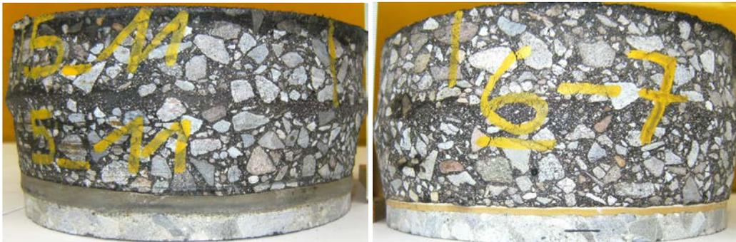
Abb. 8.7 Deformationen der Prüfkörper aus Platten 5 und 6
