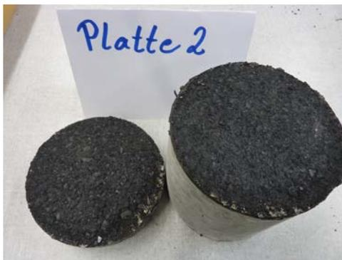
Abb. 7.13 Bohrkern der Platte 2, MA16/PBD SBS/Beton nach der Scherprüfung. Die Schichttrennung erfolgte zwischen Schutzschicht und PBD
