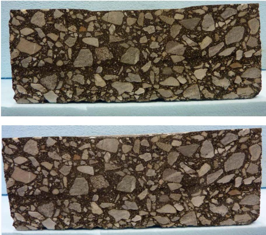
Abb. 6.8 Prüfkörper PK 2\_1 und 5\_2 nach dem Stempeleindringversuch
