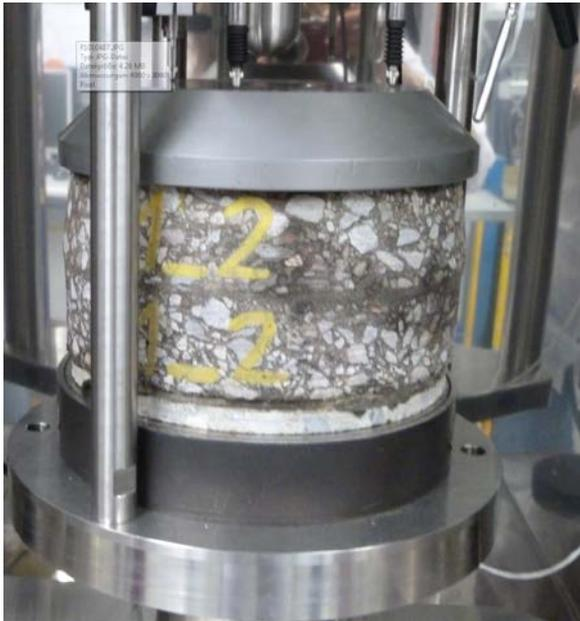
Abb. 8.1 Prüfvorrichtung Einaxialer Druckschwellversuch
