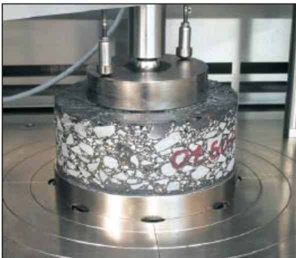
Abb. 6.1 Prüfvorrichtung Stempeleindringversuch nach (TP A-StB, Teil 25, A1)
