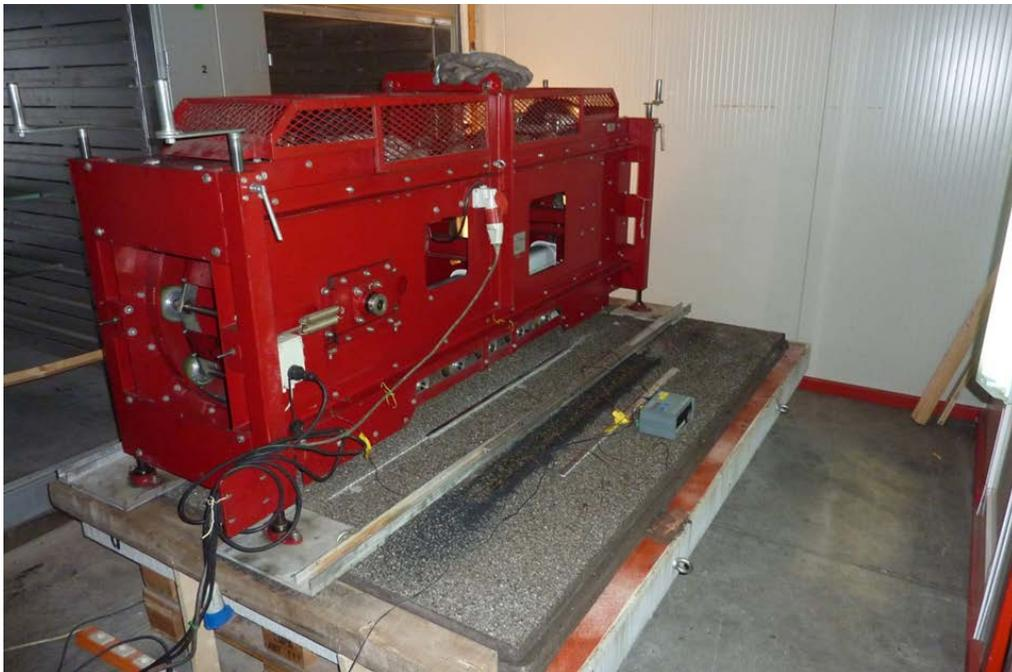
Abb. 5.3 Prüfaufbau: Musterplatten mit Verkehrslastsimulator MMLS3
