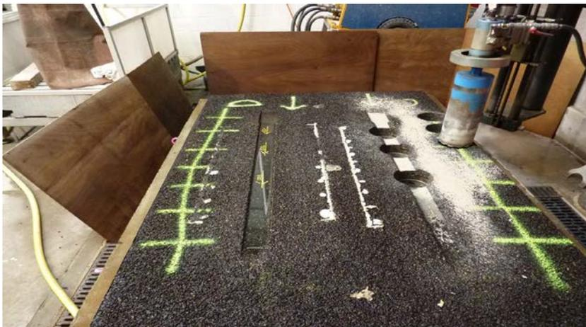
Abb. 5.12 Prüfkörperentnahme innerhalb und außerhalb der Spurrinnen
