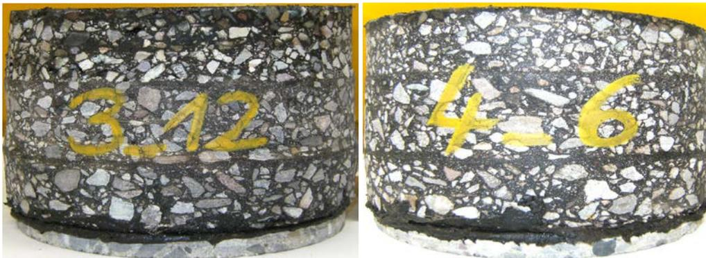
Abb. 8.8 Deformationen der Prüfkörper aus Platten 3 und 4
