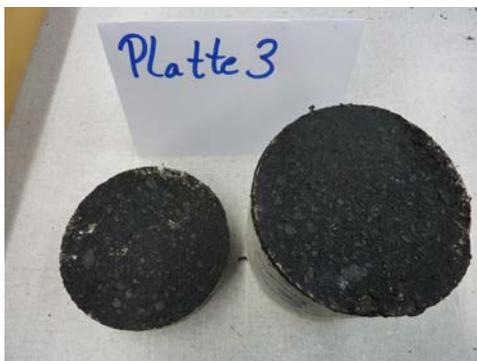
Abb. 7.14 Bohrkern der Platte 3, MA16/PBD SBS/Beton nach der Scherprüfung. Die Schichttrennung erfolgte zwischen Schutzschicht und PBD
