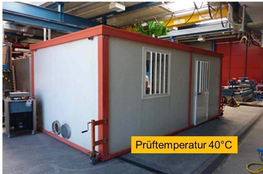
Abb. 5.4 Container dient der Temperierung während der Prüfung mit MMLS3
