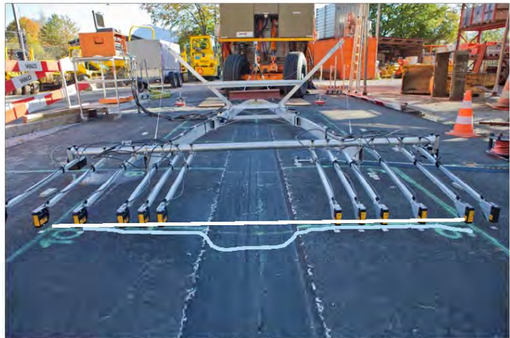
Abbildung 19: Spurrinnenbildung nach 800'00 Lastüberrollungen. "Durchstanzversagen" der Fahrbahn (hellblaue Linie=Interpretation).
