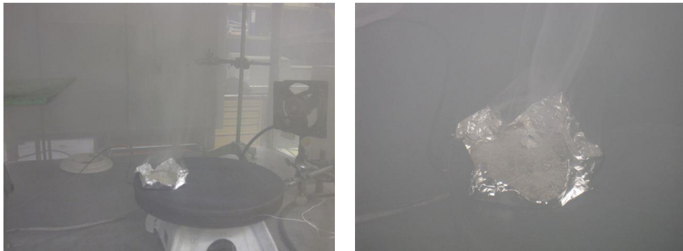
Abbildung 43: Verschmelzen von PP mit starker Rauchentwicklung. Das PP verdampft vollständig und optisch rückstandslos.
