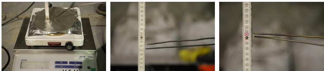
Abbildung 49: Platzierung der Thermoelemente in 0 cm, 58 cm, 100 cm Höhe
