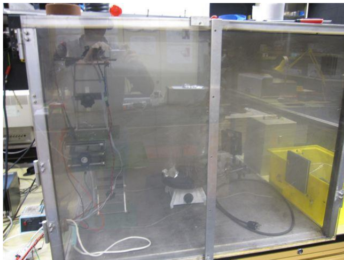
Abbildung 37: 0.6 m 3 -Brandkammer mit schwelendem PP auf einer Heizplatte mit einer Maximalleistung von 2 kW.
