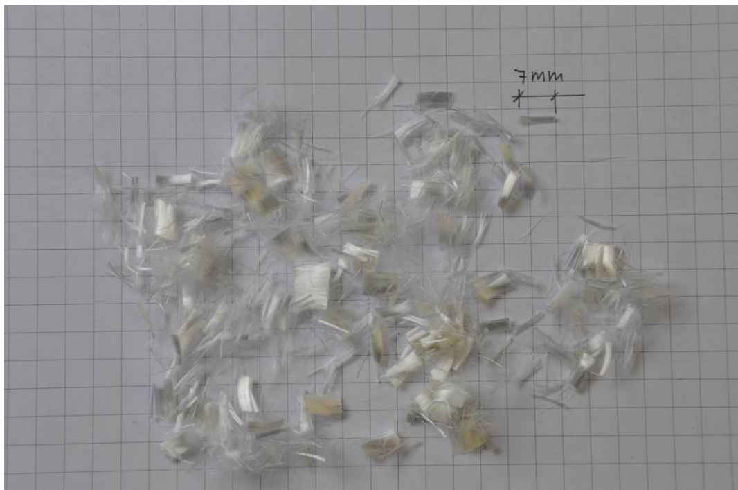
Abbildung 52: Feine PP Fasern mit einer Länge von 7 mm für die Schmauchversuche
