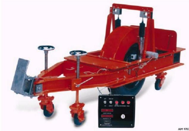
Fig. 15 : Exemple d'un appareil de type Bump Integrator
