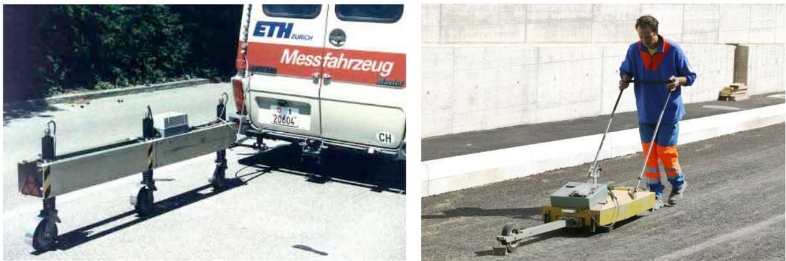
Fig. 13 : Winkelmessgerät de l'EPFZ et Goniographe de la SACR (même principe)
