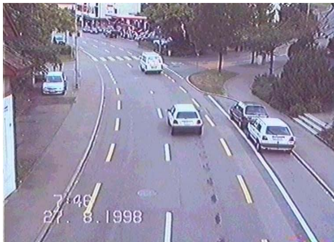
Videobild 12: Ausgeprägtes Spurverhalten bei Vorhandensein einer Leitlinie (Bassersdorf)
